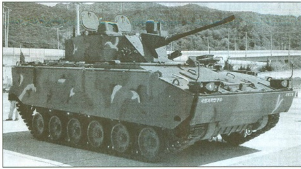
Foto's van de KAFV tonen de aanwezigheid van elektronische beschermingsapparatuur op de toren. Voorts heeft
